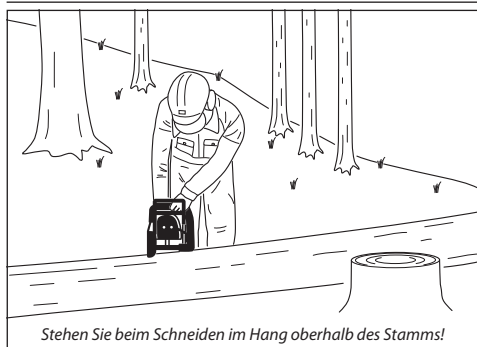
Stehen Sie beim Schneiden im Hang oberhalb des Stamms!
