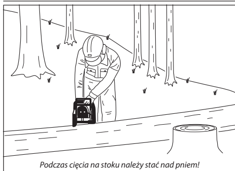
Podczas cięcia na stoku należy stać nad pnem!
